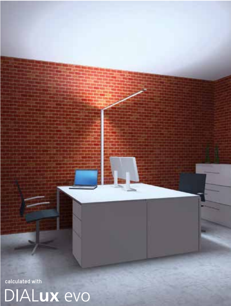
Normkonforme Ausleuchtung eines Doppelarbeitsplatzes 160 x 80 cm mit einer Gleichmäßigkeit > 0,6 Standard-compliant illumination of a double work station 160 x 80 cm with a uniformity > 0,6
