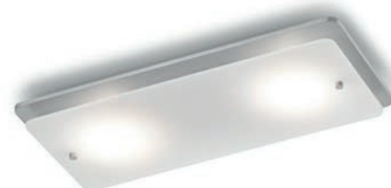
PIA-2 91.347.05 mattnickel 2 x 10 W LED, 1.960 lm, 2.700 K, Ra > 90 Energieeffizienzklasse A+ zentral dimmbar über Phasenabschrittdimmer flacher Aufbau durch Magnethalterung
