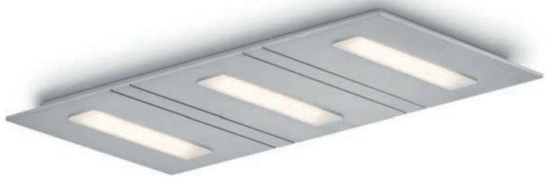
SINA-3 91.354.05 mattnickel 3 x 13,6 W LED, 5.250 lm, 2.200 - 2.900 K, Ra > 90 Energieeffizienzklasse A+ flacher Aufbau durch Magnethalterung zentral dimmbar über Universal Triac LED Dimmer 2-100 W mit dim to warm Technologie
