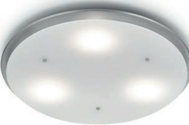
PIA-R3 91.352.05 mattnickel 3 x 10 W LED, 2.940 lm, 2.700 K, Ra > 90 Energieeffizienzklasse A+ zentral dimmbar über Phasenabschrittdimmer flacher Aufbau durch Magnethalterung
